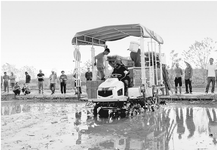
近日，我市首台水稻有序抛秧机在港南区桥圩镇锦桐村亮相，吸引来自周边乡镇的农机专业合作社代表、农机企业代表、种粮大户等前来观摩学习。据悉，该机械为14行水稻抛秧机，相较于传统插秧机，可提高作业效率1倍以上，一天可以抛秧40多亩。
