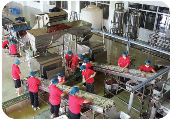
新鲜荔枝脱壳去核榨汁生产线。
